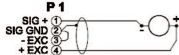
**2 WIRE LOOP POWERED PROBES**
