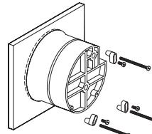
Haga una apertura de 4-9/16 pulgadas en el panel. Inserte el medidor y asegure con los herrajes de montaje provistos.
