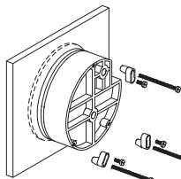
Perfore un círculo de 115 mm de diámetro en el panel, y sostenga el instrumento mediante los.
