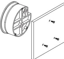
Perfore tres orificios separados 120° sobre una circunferencia de 105 mm de diámetro, y sostenga el instrumento con tres tornillos 6-32 de long. apropiada.
